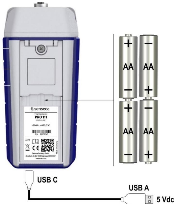
Das Gerät kann auch über den USB-C-Anschluss mit einem 5 Vdc-Standardnetzteil oder einer Powerbank betrieben werden. Wenn eine Powerbank verwendet wird, stellen Sie sicher, dass sie eine angemessene Kapazität hat und nicht über eine automatische Abschaltfunktion verfügt, wenn die Stromaufnahme sehr gering ist (geeignete Powerbanks sind zum Beispiel die der Varta Power Bank Energy-Serie).
