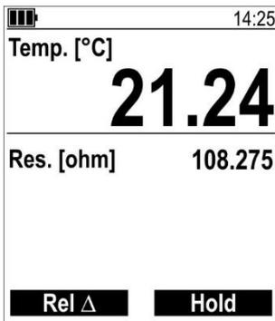
Ein Parameter wird im Großformat und die übrigen im Kleinformat angezeigt.
