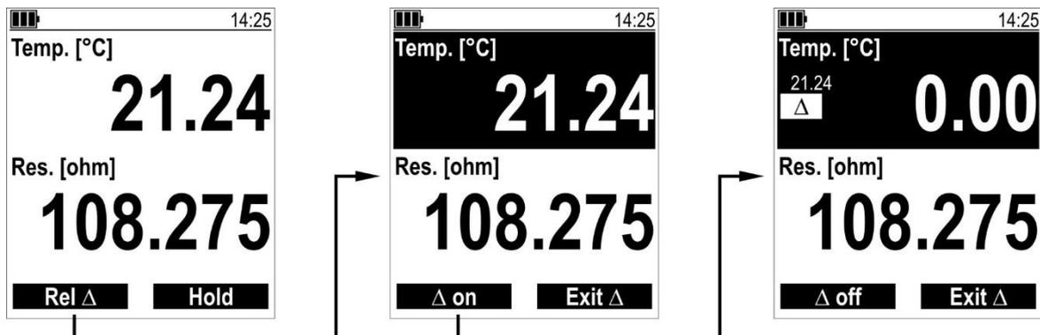
Um die relative Messung zu deaktivieren, drücken Sie erneut die linke Funktionstaste (**Δ off**).
