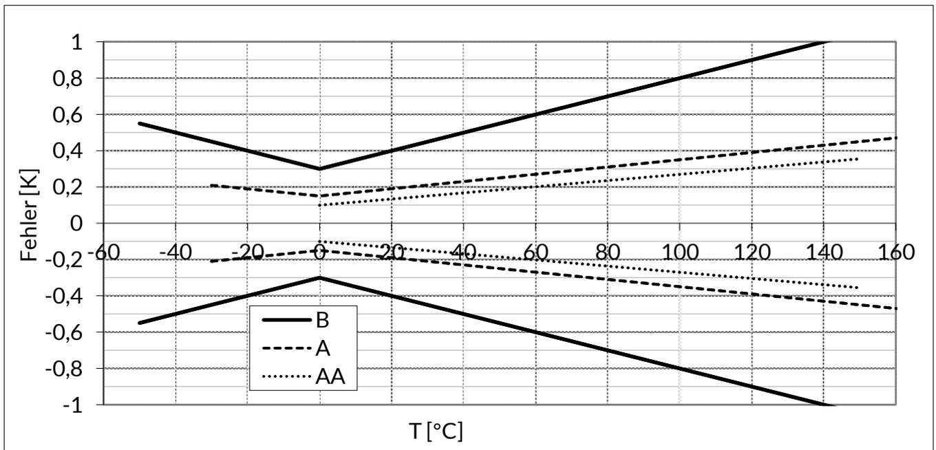
Fehlerband für drahtgewickelte Pt 100 Sensoren:
