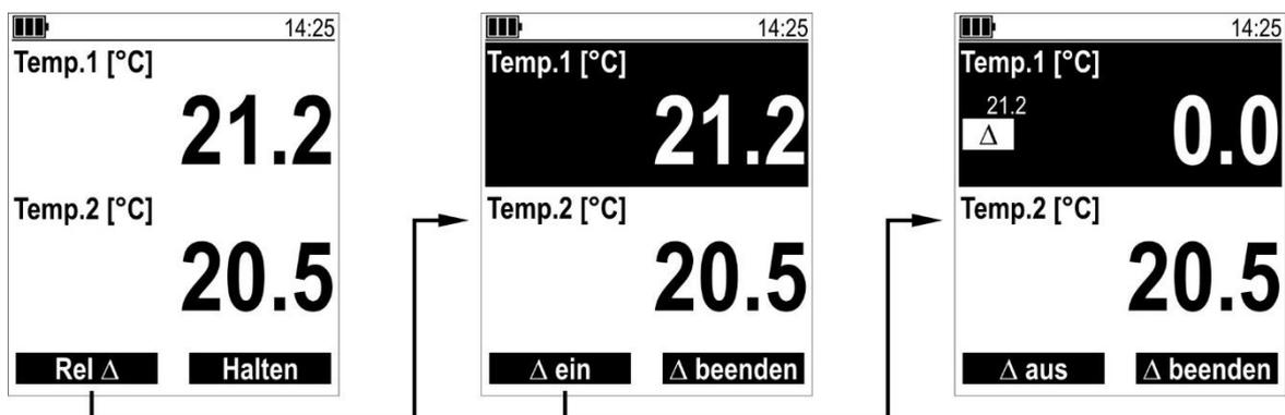
Um die relative Messung zu deaktivieren, drücken Sie erneut die linke Funktionstaste (**Δ aus**).
